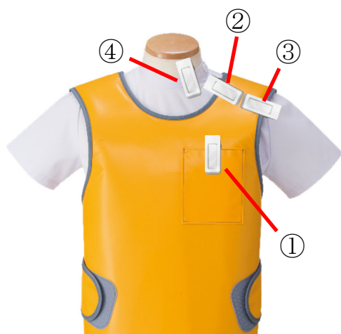
図1 現地調査した頭頸部用線量計装着箇所
